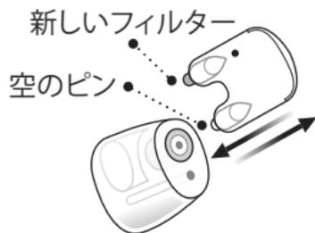
空のピンをモールドに取り付けられている古いフィルターに押し付け、引き抜きます。
