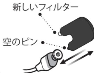
空のピンをスピーカーに取り付けられている古いフィルターに押し付け、引き抜きます。
